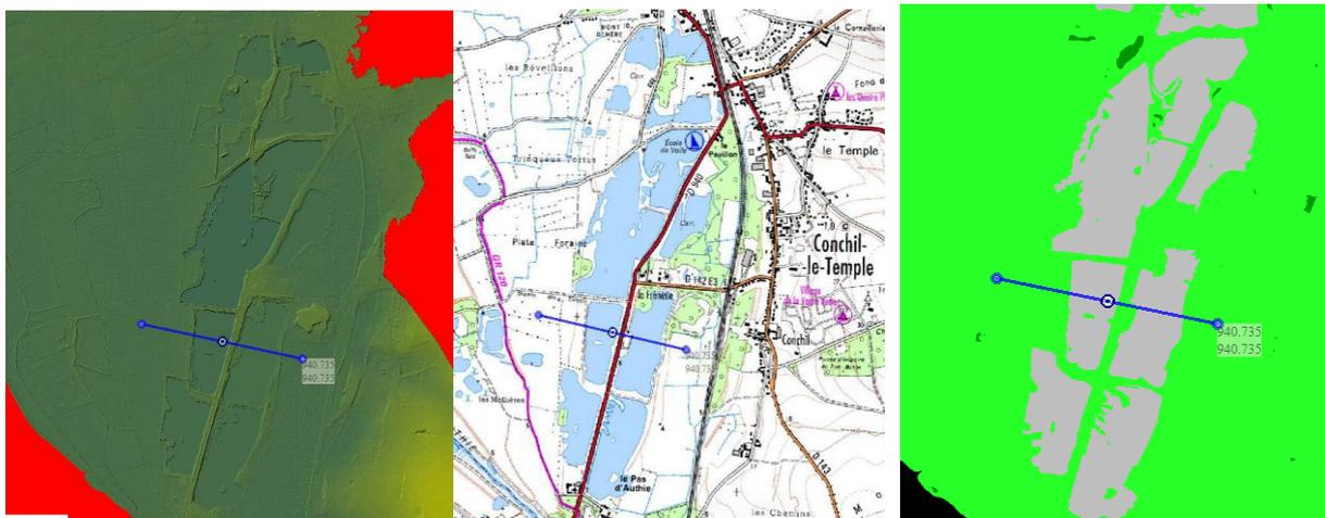
*Mise à plat d'étangs de plus d'un hectare dans le département du Pas-de-Calais (Conchil-le-Temple) dans le MNT produit à partir d'acquisitions Lidar. Sur le masque source<sup>5</sup>, à droite, les nœuds du MNT lidar situés dans ces surfaces d'eau sont codés en points fictifs (69 si acquisition IGN, 99 si acquisition externe).*
