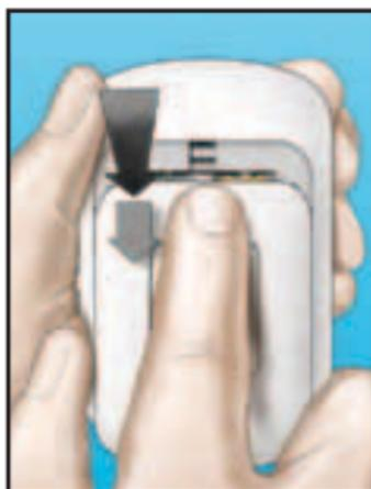
Tirez sur le ruban des piles pour sortir les deux piles du compartiment.
