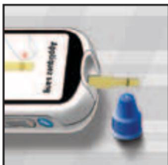
Mettez le sillon sur le côté de la bandelette réactive en contact avec la solution de contrôle. Attendez le remplissage complet du sillon.
