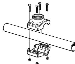
**1.** Placez le collier de serrage (A) sur le tuyau PVC, en veillant à ce que la flèche pointe dans le sens de la circulation de l'eau.
