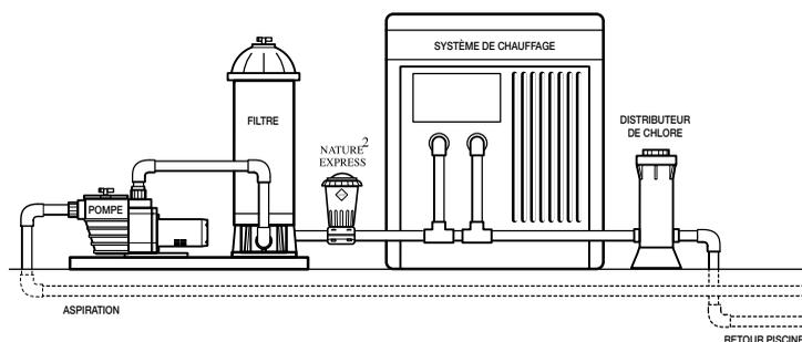
**Avertissement : si votre système de filtration se situe au-dessous du niveau de l'eau, vous devrez soit fermer la vanne de refoulement, soit utiliser le bouchon d'hivernage installé sur le ou les skimmers et le ou les refoulements pour éviter toute perte excessive d'eau.**
