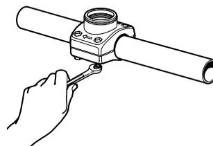
**2.** Vissez les 4 vis et écrous (A) fournis dans l'emballage. Il est normal qu'il reste un espace de quelques millimètres entre les 2 parties du collier (A).
