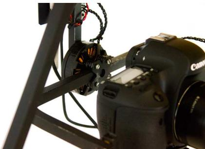
A faire à la première utilisation, réglez l'équilibre de la nacelle en jouant sur les 4 vis présentes sur le moteur à l'arrière de l'appareil et sur les 4 vis présentes sur la patte de fixation de l'appareil. Ayez au mieux l'objectif avec le moteur arrière.
