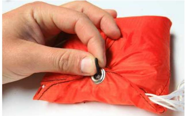
Une fois le volet fermé, passez 3 à 4 suspentes afin de verrouiller l'ouverture.
