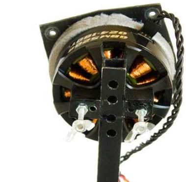
Repérez les deux axes sortant sous le moteur au sommet de la nacelle.
