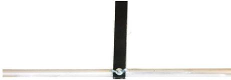
Passez la vis M3 au travers et bloquer avec l'écrou rapide, serrez fermement. Faites de même pour le deuxième patin.
