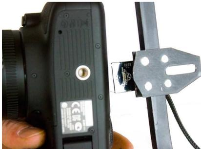
Présentez l'appareil photo numérique, il se fixe sur le trou oblong avec la vis type « trépied » fournie dans le kit.
