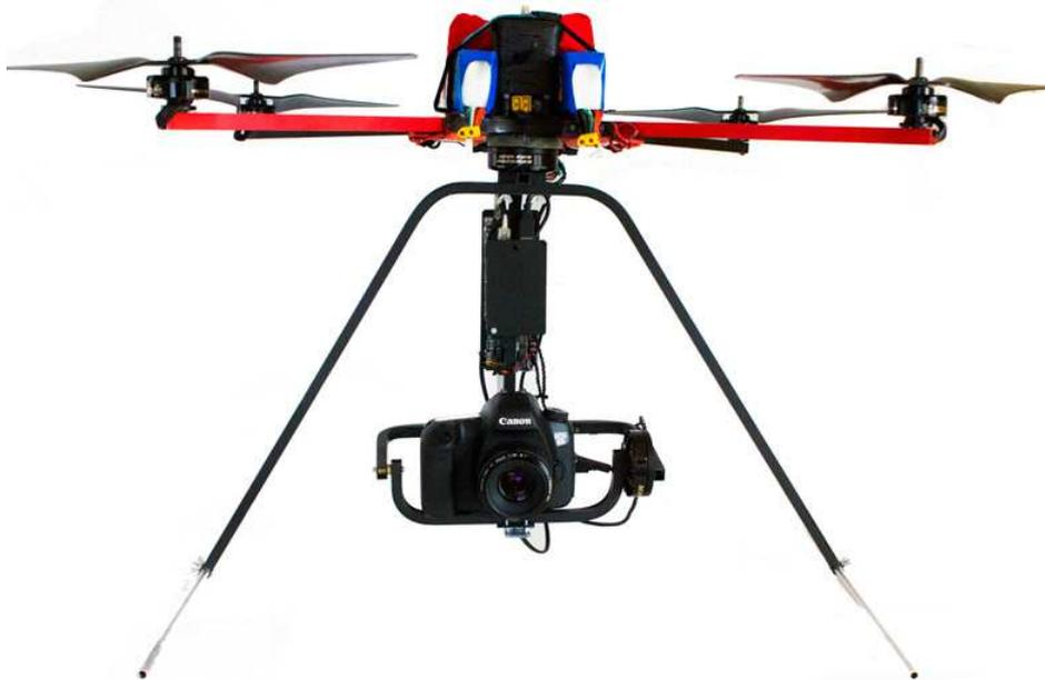
Posez les batteries principales, bien serrez le scratch de fixation, vérifiez le bon maintien des batteries. Faites votre visite prévol. Voilà, il ne vous reste plus qu'à connecter les prises des connecteurs de batterie sur les connecteurs femelles, pensez à allumer votre appareil et à connecter votre nouveau Nexus à l'application DSLR contrôler :-)
