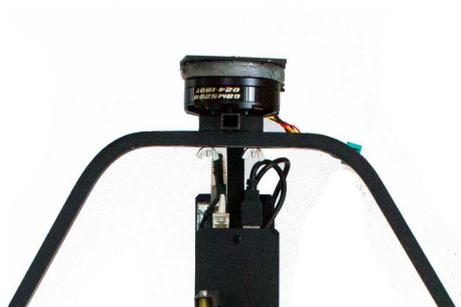
Enfilez l'arceau de pied assemblé précédemment en posant le moteur sur l'arceau et en faisant passer les axes filetés M3 par les trous.
