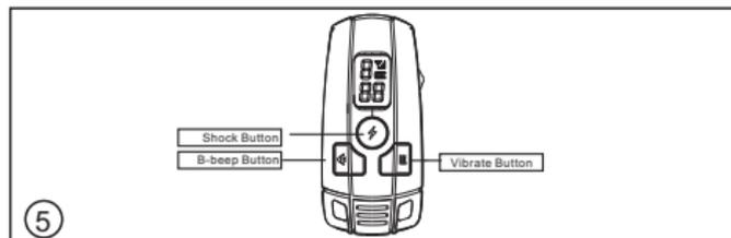
**Étape 5:** Vérifiez la fonction du bouton. Pressez le bouton bip, celui-ci produira le signal sonore. Et de même, pressez le bouton vibration, celui-ci produira des vibrations. Mettez le kit de test sur les griffes métalliques pour tester le choc. Appuyez sur le bouton Choc et l'ampoule s'allumera.
