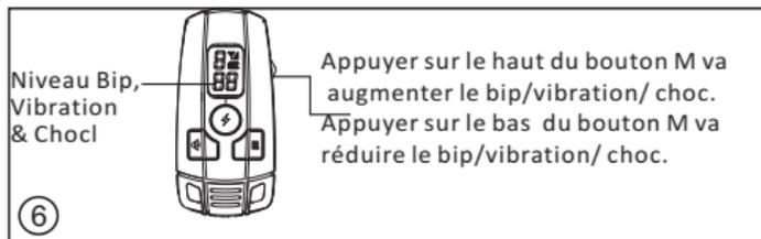
**Étape 6:** Appuyer sur le haut ou le bas du bouton M va augmenter ou réduire le bip/vibration/ choc. 10 différents niveaux d'intensité sont disponibles.
