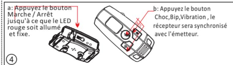
**Étape 4:** Synchronisez le récepteur et l'émetteur. Si vous venez de terminer la charge, pressez une des boutons de fonction (choc, bip, vibration) sur l'émetteur. Sinon, vous devez allumer le récepteur en appuyant le bouton Marche / Arrêt jusqu'à ce que le LED rouge soit allumé et fixe. Une fois que le récepteur et l'émetteur sont synchronisés, le LED rouge s'éteint et le LED bleu clignote toutes les 10 secondes.
