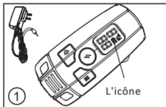
**Étape 1:** Chargez l'émetteur. L'icône d'électricité se déplace de bas en haut pour indiquer le processus de charge.
