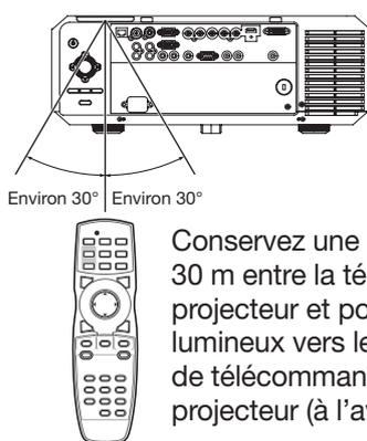
Conservez une distance de 30 m entre la télécommande et le projecteur et pointez le faisceau lumineux vers le capteur optique de télécommande situé sur le projecteur (à l'avant ou à l'arrière).
