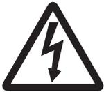
Le symbole de l'éclair dans un triangle équilatéral est destiné à prévenir l'utilisateur de l'existence d'une "tension dangereuse" non isolée à l'intérieur du châssis et suffisamment élevée pour représenter un risque d'électrocution.
