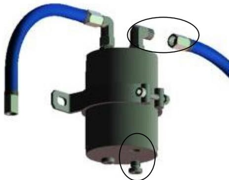
*Si la vidange de l'épurateur n'est pas accessible, débrancher les flexibles de l'épurateur et le sortir du collier pour le vidanger.*
