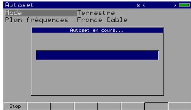
7/ Une fois la recherche terminée, l'appareil entre dans le Mode Plan de Mesure. Il affiche alors différentes mesures (Niveau, MER...) pour les programmes trouvés.
