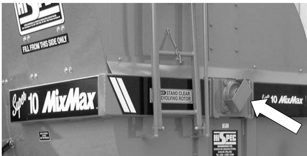
14 Point de graissage à l'arrière de la machine
