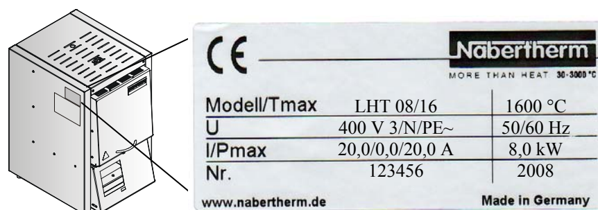
Fig. 2 : Exemple de désignation de modèle (plaque signalétique)
