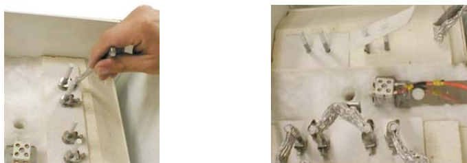
Fig. 26 : Retirer le porte-résistance et l'isolation
