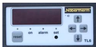
Fig. 44 : Sécurité de température réglable TL6
