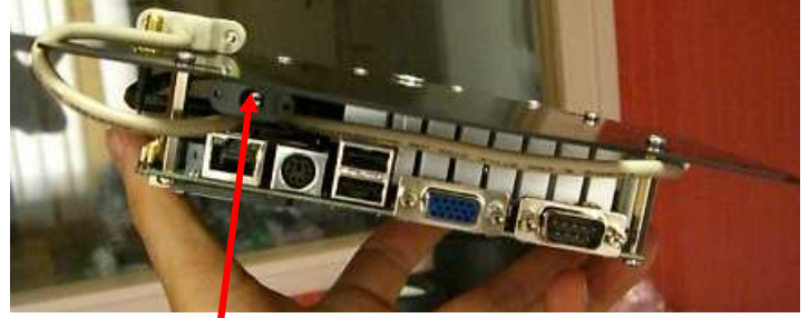
Le connecteur pour alimenter le CPU indépendamment du robot
