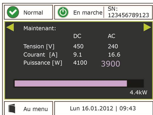
Les valeurs de courant PV (DC) et d'alimentation (AC), de tension et de puissance s'affichent sous forme numérique. La puissance de sortie instantanée est présentée sous la forme d'un graphique à barres.
