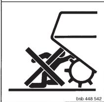
Ne pas s'approcher de la zone de danger par écrasement, aussi longtemps que des pièces y sont encore en mouvement.
