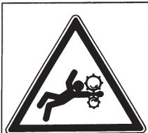
Ne jamais s'approcher du pick-up aussi longtemps que le moteur du tracteur est en marche et que le cardan est branché au tracteur.
