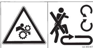
Si le moteur du tracteur est en marche ne pas s'approcher de la porte arrière. Avant de monter, placer des cales de sécurité.
