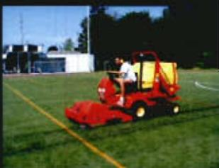
Machine de nettoyage du remplissage
