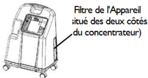
**Figure 1** - Emplacement du filtre
