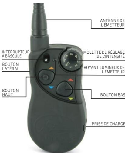
**ÉMETTEUR :** transmet le signal radio au collier-récepteur. Étanche, il peut être plongé dans l'eau, jusqu'à une profondeur de 7,6 m.
