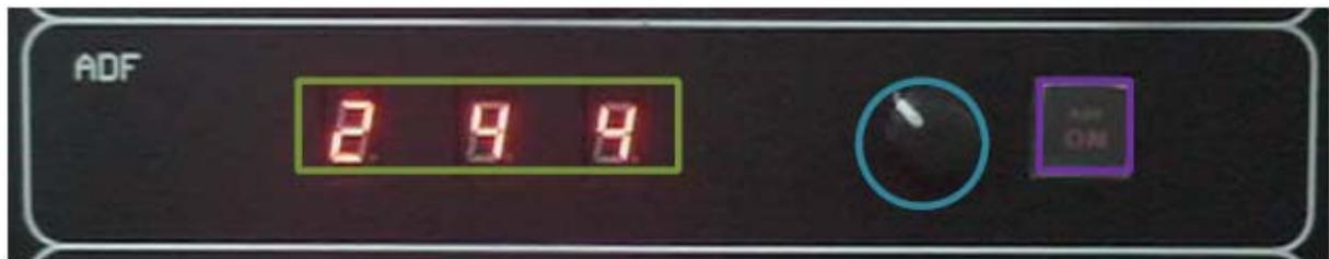
**Unité ADF** : 1 bouton rotatif, un bouton tactile lumineux, 3 chiffres digitaux lumineux affichant la fréquence ADF
