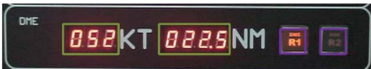
**Unité DME** : 2 boutons tactiles lumineux. 3 chiffres lumineux et 4 autres chiffres lumineux affichant la vitesse de l'avion et la distance entre celui-ci et le VOR.
