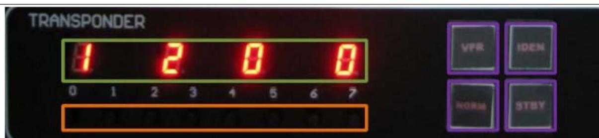
**Unité Transpondeur** : 8 boutons tactiles, 4 boutons tactiles lumineux. 4 chiffres digitaux affichant le code transpondeur
