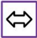
Permet de permuter la position de la fréquence Standby en position Active et vice-versa
