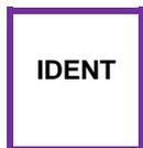
Envoie le signal "**IDENT**" (identification) de l'appareil vers l'ATC
