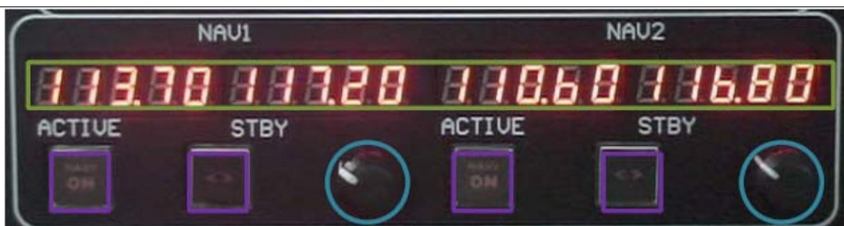
**Unité NAV** : 2 boutons rotatifs, 4 boutons tactiles lumineux. NAV1 / NAV2 visibles grâce aux 5 chiffres digitaux lumineux affichant les fréquences Active et Stanby des NAV AID (VOR, VORTAC, DME, ILS)
