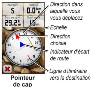
Le pointeur de cap indique la déviation (vers la droite ou la gauche) selon l'échelle indiquée au bord de l'anneau du compas.
