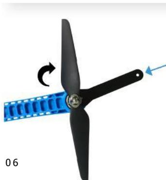
**Pour retirer l'hélice**, Bloquer le moteur avec l'outil hélice et tourner l'hélice dans le sens de déverrouillage.
