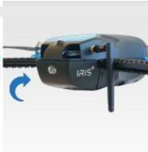
Insérez la batterie et fixez le connecteur jaune. Pour fermer, relevez la porte jusqu'à ce qu'elle s'enclenche, veiller à ce que les câbles de batterie n'interfèrent pas avec les câbles de LED.
