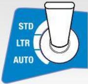
Positionnez l'interrupteur Mode sur standard (STD)
