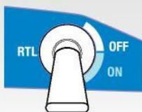
Pour rappeler l'IRIS lors d'une mission, utiliser la radiocommande pour passer sur standard (STD) et atterrir manuellement. Ou passez sur RTL pour revenir automatiquement au point de lancement.
