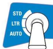
Sélectionnez le mode auto à effectuer une mission autonome. IRIS suivra automatiquement la série de waypoints enregistrés dans le pilote automatique. Voir pages 19 et 20 pour obtenir des instructions sur la planification et des missions de vol.
