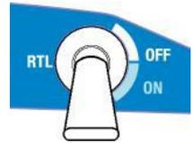
Réglez le commutateur RTL sur ON pour mettre fin au vol et faire revenir automatiquement IRIS à son point de lancement. Assurez-vous que le commutateur RTL est sur OFF avant le décollage.
