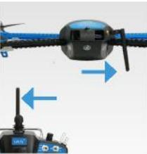
Vérifiez que les antennes de l'IRIS et de l'émetteur sont orientées verticalement pour obtenir le meilleur signal.
