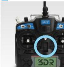
Assurez-vous que l'émetteur est toujours allumé lorsque IRIS est alimenté. Si la communication avec l'émetteur est perdue, IRIS lancera un atterrissage de récupération automatique (R.T.L.).
