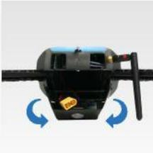
Appuyez simultanément sur les côtés du compartiment à batteries et faites pivoter la porte vers le bas.
