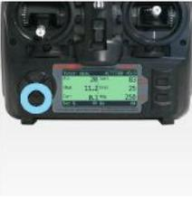
Appuyez et maintenez le bouton DN sur la radiocommande pour afficher des données de vol de l'IRIS. Voir la liste de vol pour plus d'informations sur les données de vol de la radiocommande.
