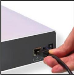
1. Connectez le connecteur du câble LAN au Freecom Network Storage Center / Network Media Center.
