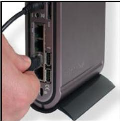
3. Connectez l'autre extrémité du câble LAN au routeur de réseau.
