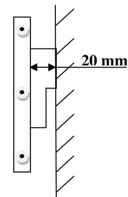
Engager la cassette, par l'intermédiaire des 4 gros trous dans les supports muraux, en face des vis (figure 3). Engager la cassette dans le sens de la glissière jusqu'à la butée (figure 4).
