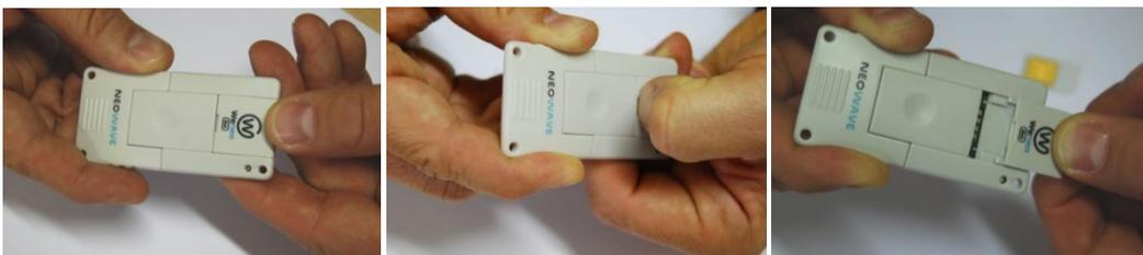
3 - Insérer la carte Moneo format Plug SIM en la glissant dans le connecteur situé dans la trappe de telle sorte que les contacts métalliques soient orientés vers le bas et que le coin biseauté de la carte SIM soit positionné dans l'angle biseauté de la trappe du Weneo SIM
