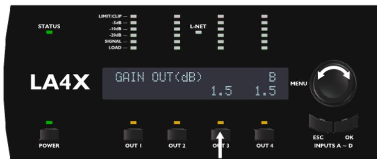
Figure 19 : Réglage du gain OUT 3
