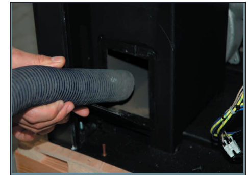
Aspirer toute la cendre qui s'est déposée dans la chambre de combustion.
