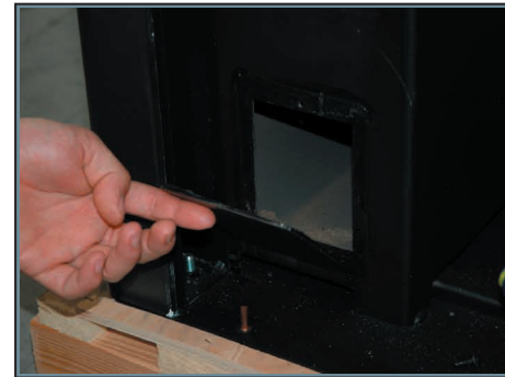
Ouvrir la porte située sous le poêle dans la partie droite en dévissant les 2 vis
