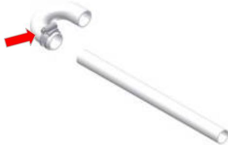
6. Insérez le tout dans le tuyau d'évacuation et fixez le coude de 90° sur l'ergot de condensât à l'aide d'un collier à vis sans fin.
