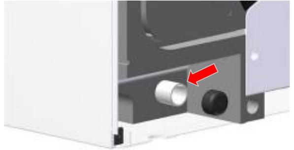
3. Insérez la conduite verticale pour le condensât et fixez-la en place à l'aide d'un collier à vis sans fin. La conduite du condensât peut être raccordée à l'aide d'un collier à vis sans fin à une conduite verticale de 22 mm de diamètre.
