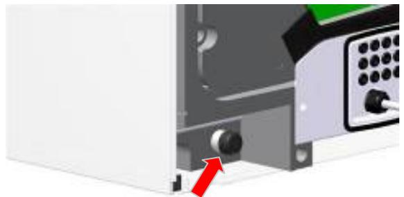
2. Retirez le bouchon noir de l'extrémité de l'embout situé à l'arrière de l'appareil.
