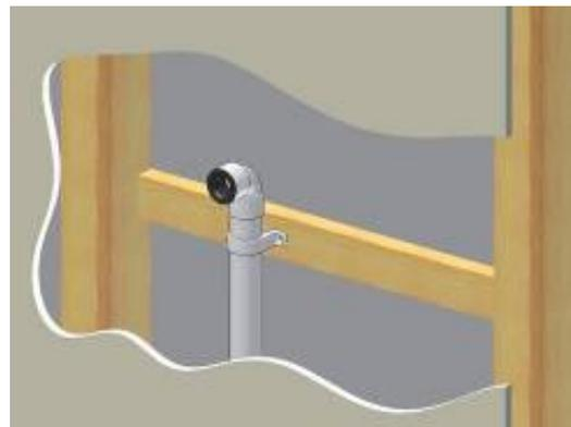
5. Installez le coude de 180°C fourni sur une conduite de purge de condensât de 22 mm de diamètre et 280 mm de long à l'aide d'un collier à vis sans fin.
