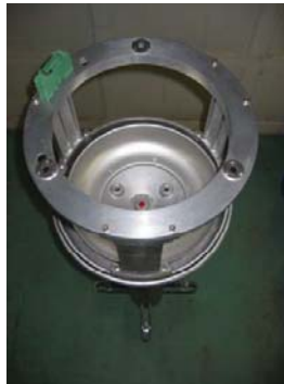
Figure 6—7. Cadre du pluviomètre sur le piédestal à la bonne orientation
