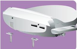
**ETAPE N°5** Assembler les écrous, rondelles et joints (fig. b, d, e, f) et fixer l'unité principale sur les toilettes à l'aide du tournevis spécial (fig. a).
