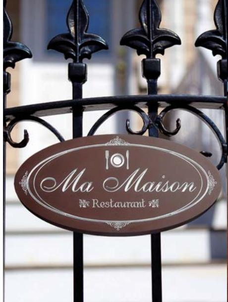
Le mode 2,5d calcule des angles vifs dans les coins des caractères gravés, un effet d'artisan. ("V-Carving")
