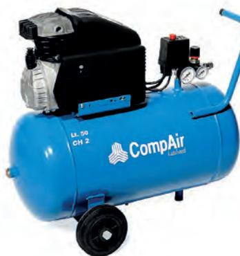
Compresseur d'air lubrifié sur roues adapté aux utilisations occasionnelles. Accouplement direct. Equipé de détendeur pour deux pressions disponible et de raccord rapide pour l'air comprimé. Mono cylindre. Alimentation : 230 V. Vitesse de rotation : 2850 tr/min. Poids : 35 kg. Niveau sonore : 70 dBa. Puissance : 2 ch. Débit réel : 8 m³/h. Pression maxi : 8 bar. Réservoir : 50 L. 1010607
