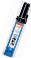
400 A à 35 %, tête monobloc chargée fibre de verre. Diamètre des électrodes : 2,5-3,2-4-5 et 6,3 mm pour câble 50 mm<sup>2</sup>. Serrage pas à droite. 013233P
