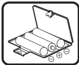
3. Insérer 3 piles LR6/AA en respectant le schéma qui se trouve dans le compartiment à piles.
