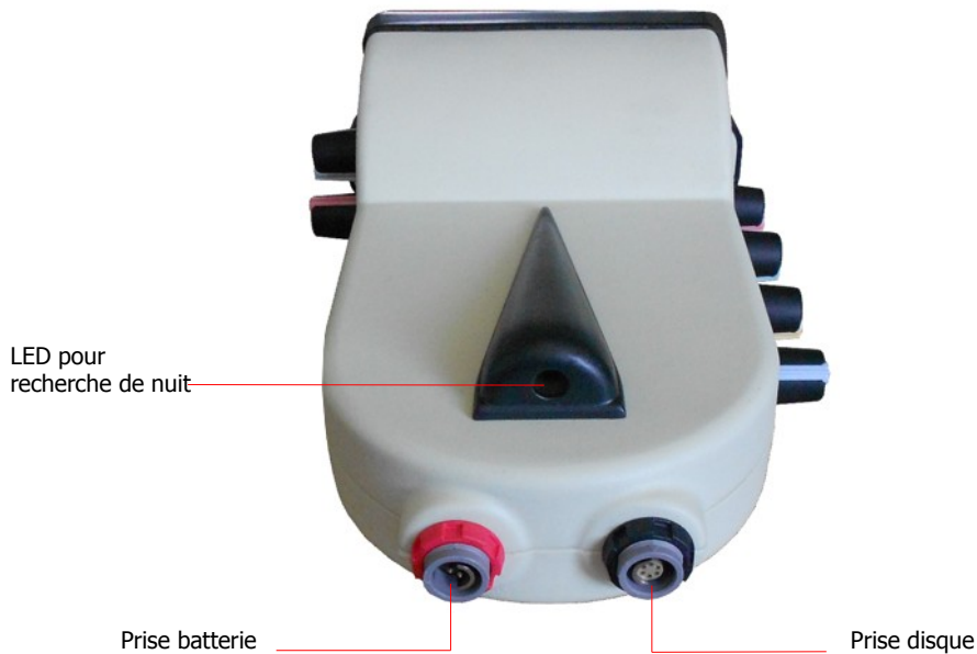
Figure 5.3: arrière du boîtier de contrôle montrant les prises batterie et disque
