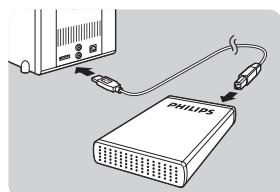
Conecte el cable USB (D) en el puerto USB del disco duro externo. Conecte el otro extremo del cable USB en un puerto USB libre de su ordenador.
