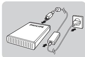
Collegare insieme adattatore di alimentazione (B) e cavo di alimentazione (C); collegarli al disco rigido esterno e ad una presa di alimentazione.
