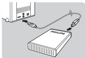
Inserire il cavo USB (D) nella porta USB del disco rigido esterno. Collegare l'altro lato del cavo USB a una porta USB libera del computer.
