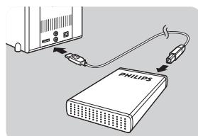
Conecte o cabo USB (D) na porta USB de seu disco rígido externo. Conecte o outro lado do cabo USB a uma porta USB vazia de seu computador.
