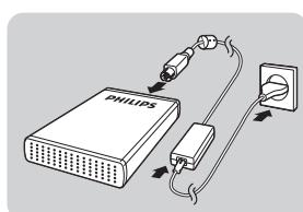
Güç adaptörünü (B) Güç kordonu (C) ile birlikte takın ve bunların harici hard disk ve güç çıktısına bağlantılarını yapın.
