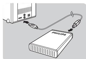
Branchez le câble USB (D) sur le port USB du disque dur externe. Raccordez l'autre extrémité du câble USB à un port USB libre de l'ordinateur.
