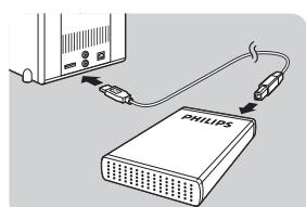
Steek de USB-kabel (D) in de USB-poort van uw externe harde schijf. Sluit het andere uiteinde van de USB-kabel aan op een lege USB-poort van uw computer.
