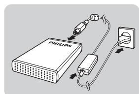
Verbind de stroomadapter (B) en het stroomsnoer (C) met elkaar en sluit ze aan op de externe harde schijf en een stopcontact.
