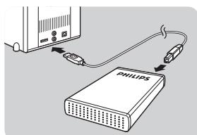
Stecken Sie das USB-Kabel (D) in den USB-Anschluss Ihrer externen Festplatte. Schließen Sie das andere Ende des USB-Kabels an einem freien USB-Anschluss an Ihrem PC an.
