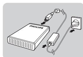
Branchez le cordon d'alimentation (C) sur l'adaptateur secteur (B) et raccordez l'ensemble au disque dur externe et à la prise de courant.
