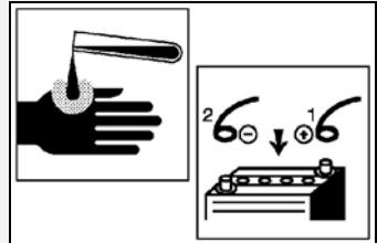
Smontare la batteria dalla macchina scollegando i poli prima di eseguire qualsiasi operazione (attivazione o rabbocco) della batteria.
