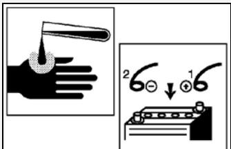
Togliere i tappi dalla batteria da ricaricare e controllare che il livello dell'elettrolito sia corretto. Collegare il morsetto positivo (+) al morsetto ROSSO (+12 V) e il morsetto negativo (-) al morsetto NERO (0 V).
