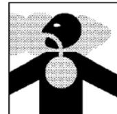
En caso de uso en el interior de ambientes cerrados, se deberán preinstalar medios adecuados para la extracción de los gases de escape (por. ej., tubos herméticos).
