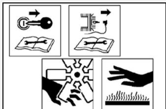
⚠ Fare attenzione durante le manutenzioni alle parti in movimento (es. pulegge, ventole) e alle parti soggette ad elevate temperature (es. marmitta, blocco motore, liquidi di raffreddamento e lubrificazione).
