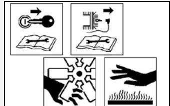
**⚠ Pendant les opérations d'entretien, faire attention aux parties en mouvement (ex. poulies, ventilateurs) et aux parties sujettes aux températures élevées (ex. Pot d'échappement, bloc moteur, liquides de refroidissement et de lubrification).**
