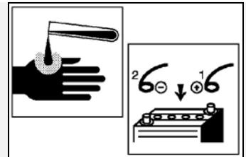
Contrôler périodiquement que le niveau de l'électrolyte soit au-dessus du niveau minimum conseillé ; si nécessaire ajouter de l'eau distillée.
