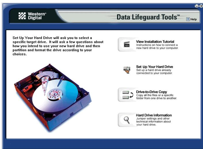
4. Une fois que les disques durs sont détectés, sélectionnez le disque à formater et partitionner comme stockage supplémentaire et cliquez sur **Next (Suivant)**. Si vous utilisez une carte hôte Serial ATA, cliquez sur l'onglet **Additional Controllers (Autres contrôleurs)** pour sélectionner le nouveau disque.
