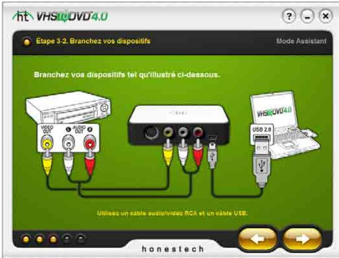
\* Les branchements illustrés ici utilisent des câbles RCA (Composite). Les branchements avec des câbles S-Vidéo diffèrent légèrement. Toutefois, une illustration indiquant les branchements avec des câbles S-Vidéo sera affichée si le type de branchements S-Vidéo est sélectionné à l'étape 3-1.
