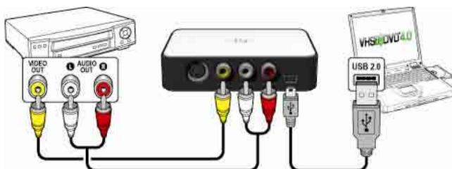
Les branchements de votre lecteur vidéo peuvent être effectués à l'aide de **câble RCA (Composite)** tels qu'illustrés ci-dessus ou à l'aide d'une combinaison de **câbles S-Vidéo et RCA audio (Composite)** tels qu'illustrés ci-dessous.
