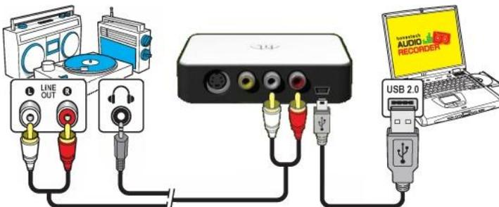
Les branchements de votre lecteur audio peuvent être effectués à l'aide de câbles **RCA (Composite)** ou à l'aide d'un **câble adaptateur Prise de casque d'écoute à RCA**.
