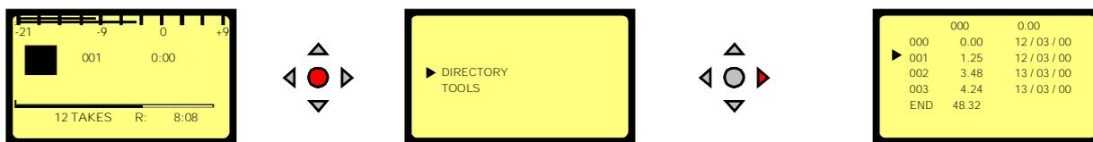
Les touches "Flèches" (9, 11, 10, 12) permettent de se déplacer verticalement et horizontalement dans le Catalogue afin de sélectionner les prises et obtenir les renseignements relatifs à chaque prise.
