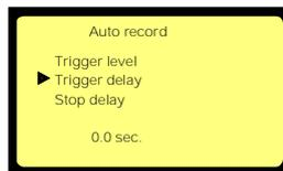
Le menu AUTO RECORD permet d'activer (ON) ou de désactiver (OFF) la mise en enregistrement automatique selon les paramètres décrits ci-après. Il suffit de placer la machine en enregistrement qui débutera alors selon les paramètres choisis.
