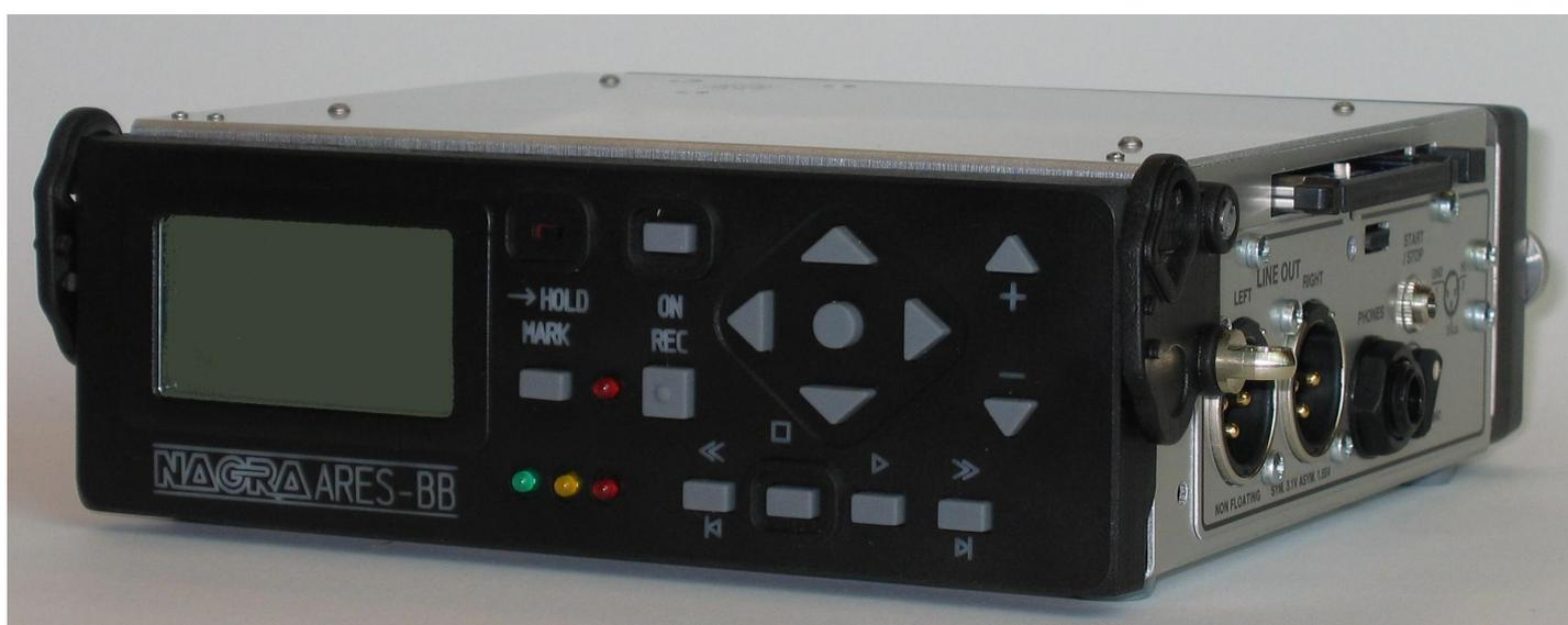
**ATTENTION :** L' ARES-BB est équipé d'un chargeur de batteries Ni-Cd ou Ni-MH (courant de charge 300 mA).
