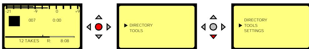
L'appui sur la touche "CENTRE" (13) permet l'accès aux sous-menus "DIRECTORY" (Catalogue), "TOOLS" (Outils) et "SETTINGS" (Configurations). Les touches "FLECHES" (9, 12, et 11, 10) permettent de naviguer à travers ces sous-menus. Le retour à l'écran principal s'effectue à l'aide de la touche flèche "GAUCHE" (10) (Sauf dans le mode "DIRECTORY", le retour aux sous-menus se fait grâce à la touche "CENTRE" (13).
