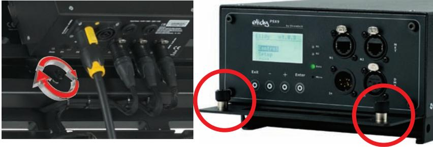
Connectez les 3 sorties (XLR 4) de la PSX 9 aux 3 entrées (XLR 4) du châssis. Branchez l'alimentation PSX 9 sur le secteur (100 -230V / 50-60Hz / 3.5A / 800W).
