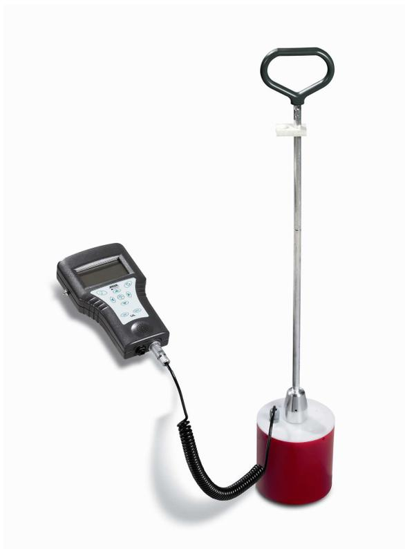
En association avec un microphone de sol (BM 30) et un générateur d'onde de choc (SSG, STG), le récepteur UL 30 sert à relocaliser précisément les défauts de câble. La bobine montée dans le BM 30 pour la mesure du temps de fonctionnement permet à l'appareil de déterminer la différence temporelle entre le signal magnétique et le signal acoustique. Cet appareil présente notamment des avantages en cas de défauts difficiles à localiser sur le plan acoustique.
