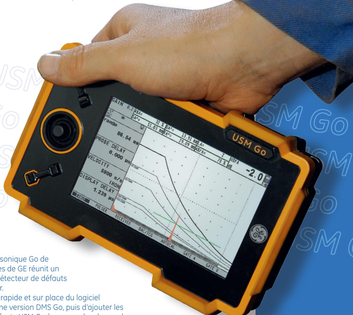
La nouvelle plate-forme ultrasonique Go de l'unité Inspection Technologies de GE réunit un mesureur d'épaisseur et un détecteur de défauts dans un seul instrument léger.
