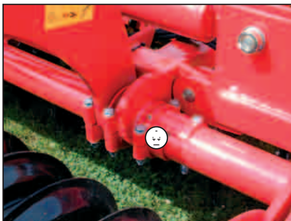
Points de graissage : Paliers de levage d'arbre packer
