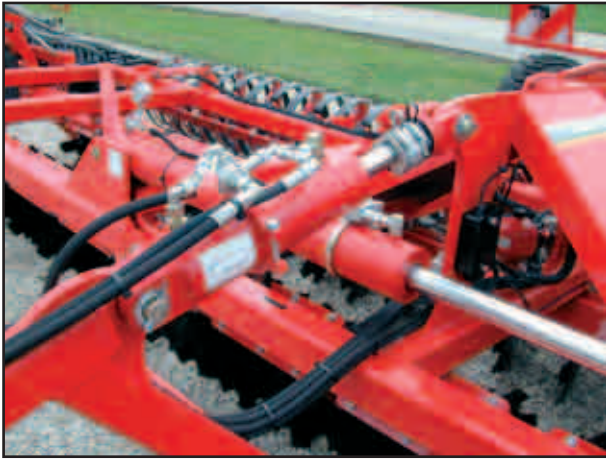
Réglage de profondeur et robinet d'arrêt sur le timon de traction
