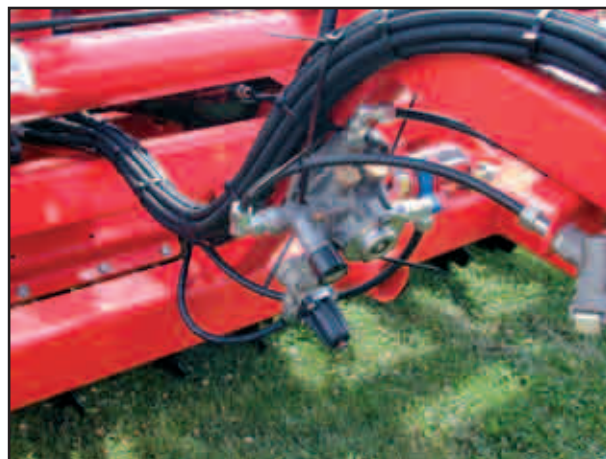
Filtre de conduite et soupape de freinage de la remorque
