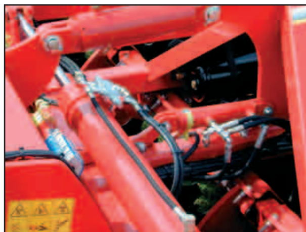
Vérin hydraulique "Packer" avec clips en alu
