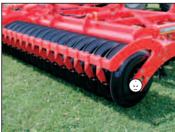
Points de graissage : Paliers du packer
