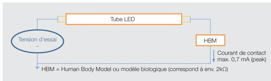
Figure 2 Schéma de mesure du courant de contact.
