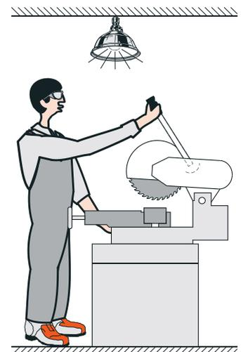
Figure 5: fonctionnement normal d'une scie circulaire
