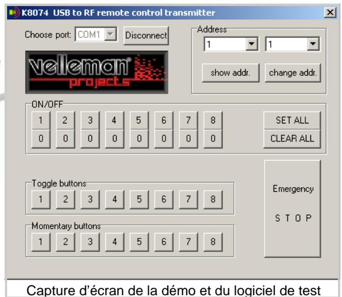
Capture d'écran de la démo et du logiciel de test
