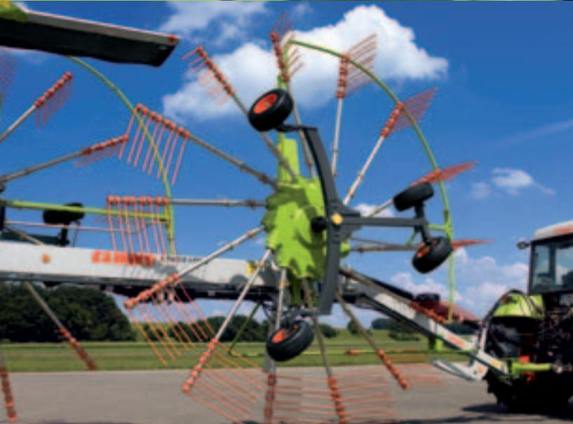
Essieu large et suivi du sol efficace des rotors avec les châssis rotors à 4 et 6 roues.
