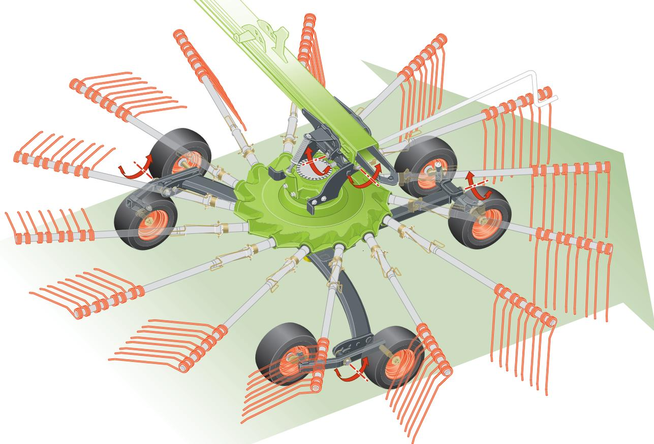
Les LINER 1750 et 1650 TWIN peuvent être équipés en option d'un châssis 6 roues. Les roues supplémentaires sont montées sur un essieu tandem pendulaire. Elles optimisent l'adaptation au sol et par là-même la qualité du travail et du fourrage.
