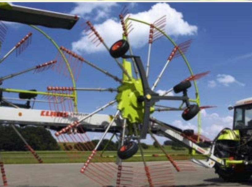
Voie large et guidage sûr des rotors : le châssis des rotors à 4 ou 6 roues.
