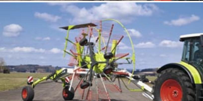
Le comportement routier particulièrement stable grâce au centre de gravité bas de la machine sur les andaineurs à dépose latérale LINER 1650 TWIN et 1750 garantit un transport sûr, même à des vitesses élevées (jusqu'à 50 km/h).
