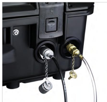
Raccordement aisé aux prises de pression courantes
