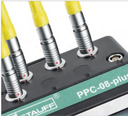
PPC-08-plus avec 4 entrées de capteur
