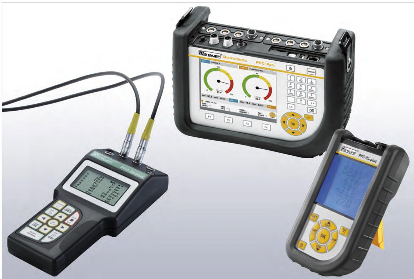
Les appareils de mesure STAUFF de la gamme PPC sont adaptés pour mesurer tous les paramètres pertinents dans les systèmes hydrauliques, tels que la pression, la pression différentielle, la température, le débit et la vitesse de rotation.
