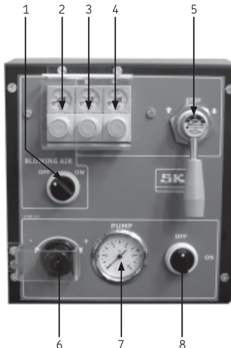
Fig. 2 Pupitre de commande de la pompe extrudeuse
