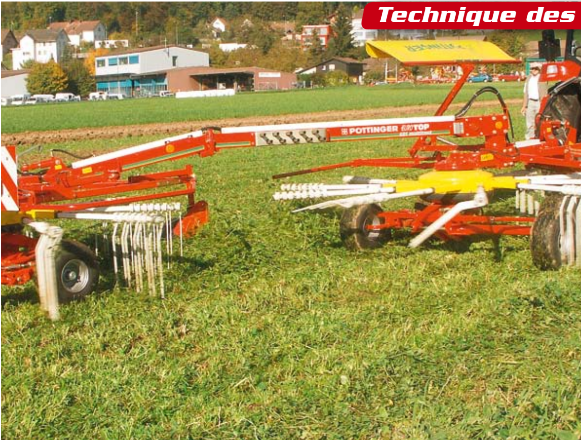
Adaptation perpendiculaire de la toupie arrière grâce à un système rotatif et une attache articulée entre le cadre et la toupie de l'andaineur Pöttinger Eurotop 601.
