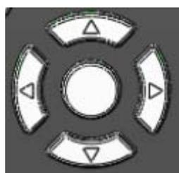
Les flèches et la touche centrale Entrée permettent de sélectionner les menus et les sous-menus et de modifier des valeurs numériques.
