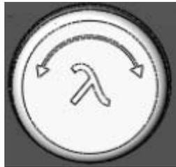
Bouton Longueur d'onde : En utilisation SPECTRONIC 200 et SPECTRONIC 20 Emulation, l'utilisateur peut régler la longueur d'onde en tournant ce bouton. La rotation du bouton (sans appuyer dessus) permet de modifier la longueur d'onde par incréments de 10 nm. Pour un contrôle précis de la longueur d'onde (incrément de 1 nm), appuyez sur le bouton  $\lambda$  et tournez-le.
