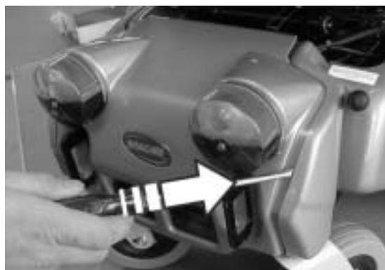
L'illustration de droite montre les positions du module d'éclairage/réglage et du module principal du système ACS. Le module principal Shark se trouve exactement à la même position que le module principal ACS.
